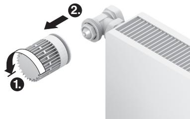
1. Starou termostatickou hlavici otočte doleva až na doraz a uvolněte z upevnění.
