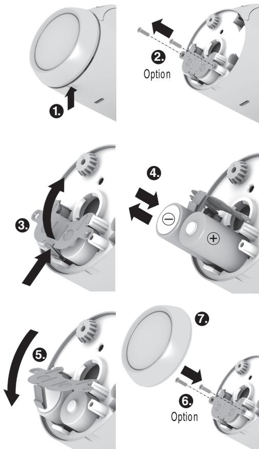
1. Stáhněte seřizovací kolečko. K zachycení použijte drážku na spodní straně přístroje.
