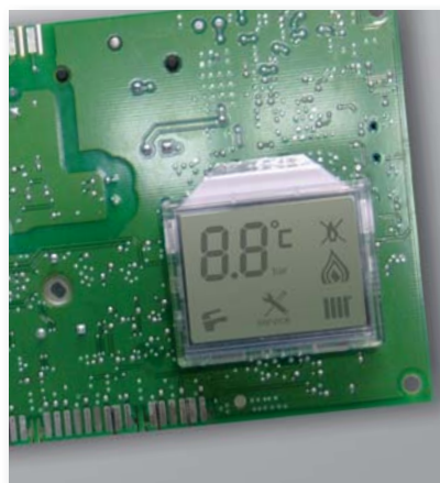
Ovládací automatika HONEYWELL s mikroprocesorem
